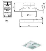
Technische Daten Philips LED Deckenstrahler LuxSpace Quadrat DN572B VLC-E 16.5W 2200lm 80D - 830 | 214mm - Aluminium Reflektor - Dali Dimmbar
