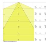
**Caractéristiques Ledvance TruSys Performance Rail System 50W 8000lm - 840 | Faisceau lumineux étroit**
