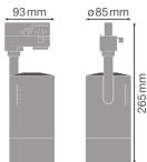
**Caractéristiques Ledvance Spot LED sur rail D85 Noir 25W 1500lm 15-55D - 830 | Mechanical Zoom - Dimmable**
