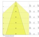
**Caractéristiques Ledvance TruSys Performance Rail System 35W 5600lm - 840 | Very Faisceau lumineux étroit**
