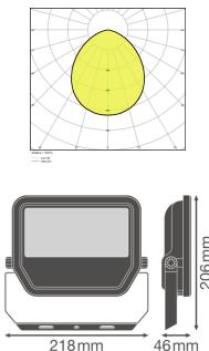
**Caractéristiques Ledvance Projecteur LED GEN 3 Noir 50W 5500lm 100D - 830 | IP65 - Symétrique - Remplacement 100W**
