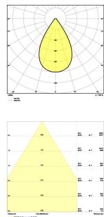
**Caractéristiques Ledvance Highbay LED Sensor Gen4 147W 22000lm 70D - 840 | IP65 - DéTECTEUR de mouvement et de lumière**
