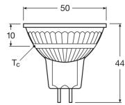
**Caractéristiques Ledvance Spot LED GU5.3 MR16 2.6W 350lm 36D - 827 | Remplacement 20W**
